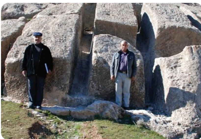
شکل ۱-۴- برش چهار طرف سنگ با تیشه در معدن بانس (عکس از: محمد جعفر ملک‌زاده)
